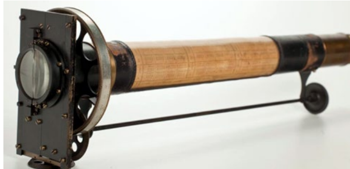
Figura 5 - Luneta Micrométrica - fabricante Etienne Lorieux - também conhecida como Micromêtro de Lugeol
