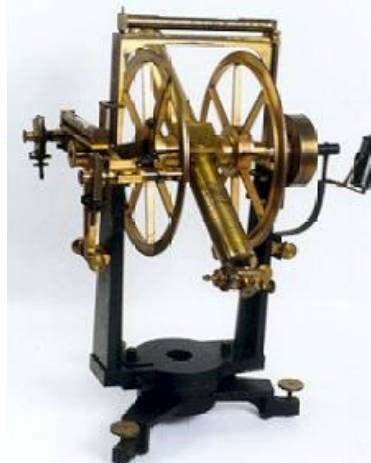
Figura 4 – Círculo Meridiano Brunner- também chamado de Luneta
